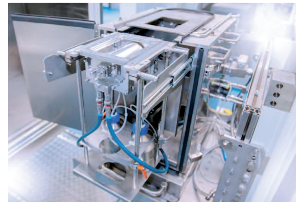
Das Flüssigkeitsrollensystem in der Prototyp- und Forschungsanordnung: Die Entwicklung des automatisierten Prozessmoduls macht diese Technologie leicht skalierbar und einsatzbereit für die pharmazeutische Industrie.
